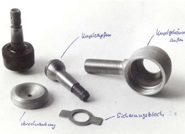
Die Spurstangen-Einzelteile des Trabant
